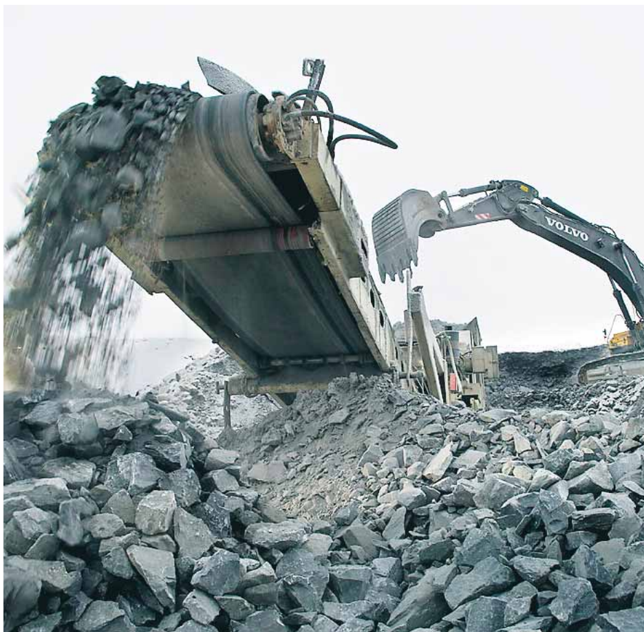
I Sverige är det mycket ovanligt att man endast använder helkross som ballast vid betongtillverkning.
