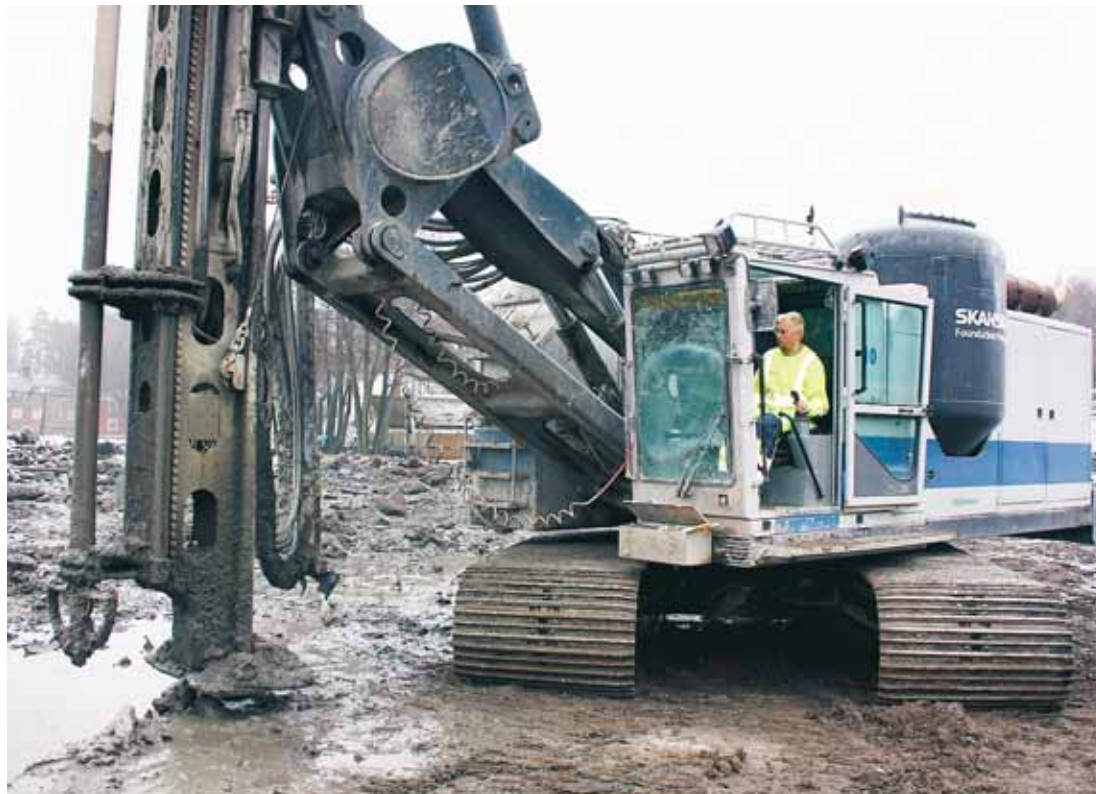
Skanskas senaste tillskott bland KC-maskinerna kan göra upp till 1 000 meter KC-pelare per dygn.
